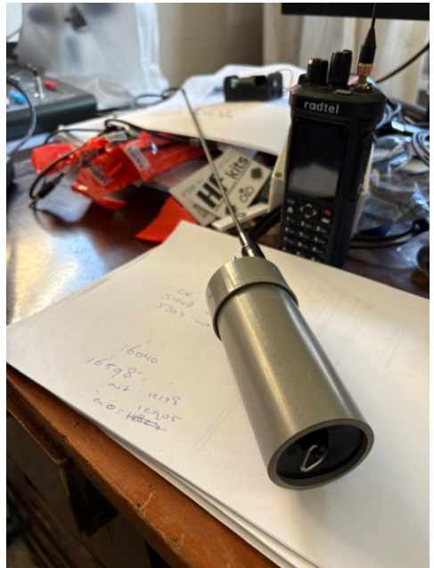
Figuur 5 – Afgebouwde zender met gootsteenplug
